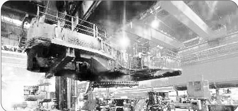
بیرینگ برج پاتیل گردان ماشین شماره ۲ ریخته‌گری فولاد مبارکه پس از ۳۰ سال بهره‌برداری مداوم، برای نخستین
